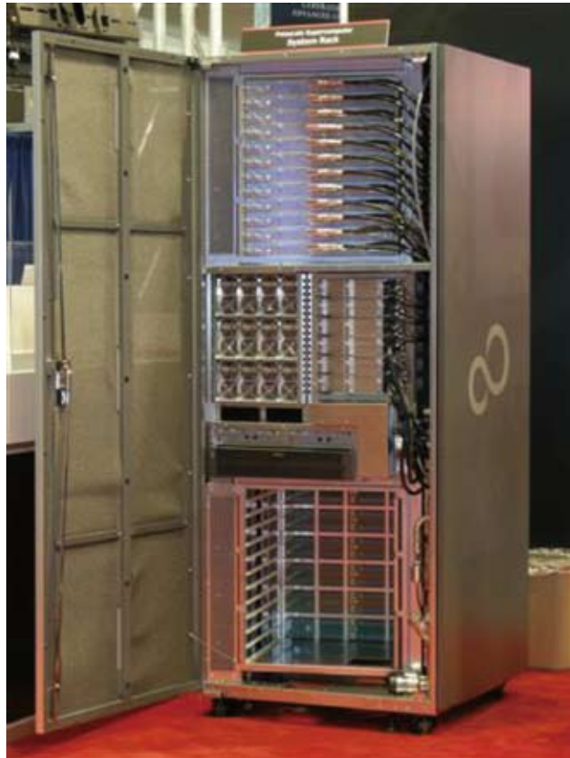
図 12 コールドプレート搭載スーパーコンピューター Fig. 12. Rack of super computer equipped cold plate units.
