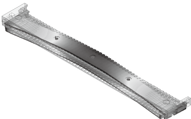
図 4 FF コネクタの変形 Fig. 4. Deformation of FF connector.
