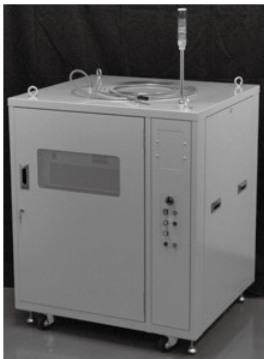
図9 試作したキロワット級ファイバレーザの外観 Fig. 9. Appearance of a trial sample of a kilo-watt CW fiber laser.
