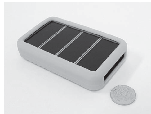
図11 4直列 DSC モジュールを用いたワイヤレス温度センサ
