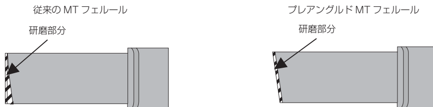
図5 従来の MT フェルールとの研磨量の比較 Fig. 5. Polished region comparison between standard MT ferrule.
