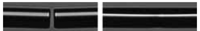
図9 接続前後のファイバの様子（左:接続前 右:接続後 Fig. 9. Fiber image on the splicer's LCD. L : Before splicing R : After splicing
