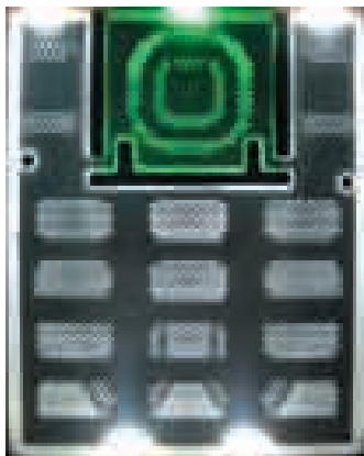
図 13 多色照光 LGF Fig. 13. Multi color LGF.
