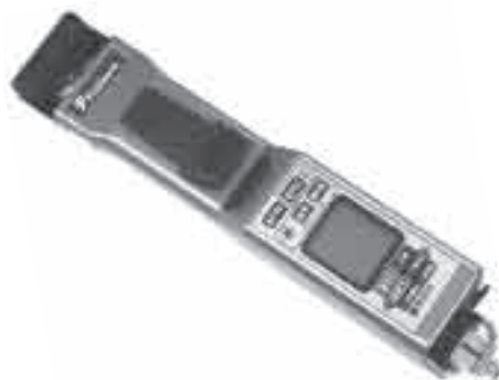
図1 新型光ファイバ心線対照器の外観 Fig. 1. Appearance of new optical identifier.
