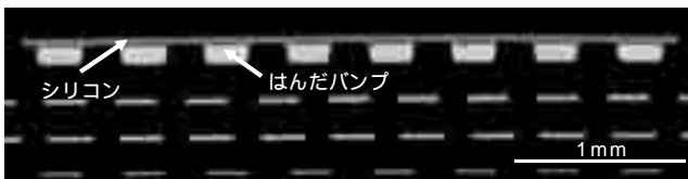
図 7 基板実装した極薄型 WLP の断面写真 Fig. 7. Cross section image of the ultra-thin type WLP mounted on PWB.
