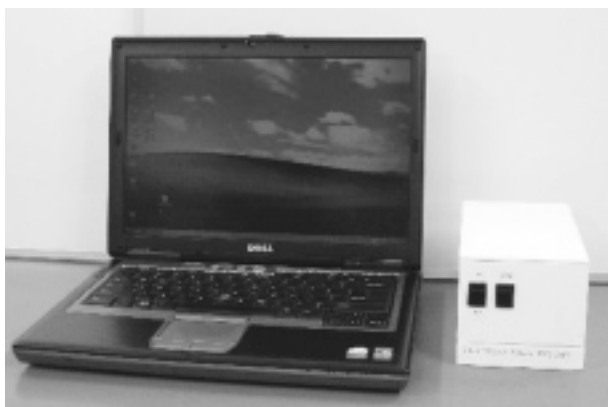
図4 燃料電池試作品（右側） Fig. 4. Prototype of DMFC.
