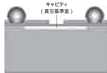
図2 パッケージング後のWLP超小型絶対圧センサの断面構造
