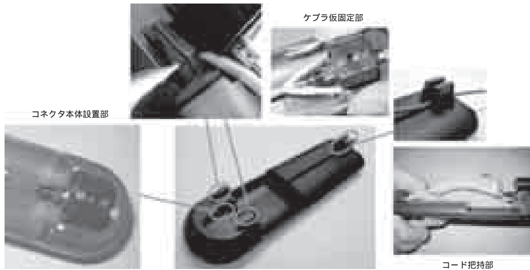
図8 組立補助治具機能の内容 Fig. 8. Feature of new assembly jig.
