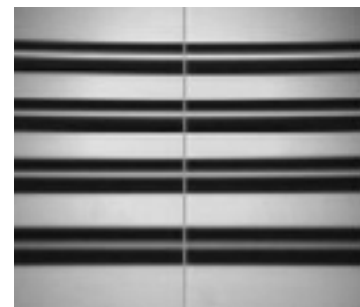
図6 レンズ改造後の光ファイバ画像 Fiber image after lens modification
