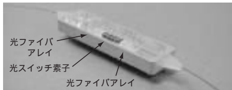
図7 内部構造 Internal structure
