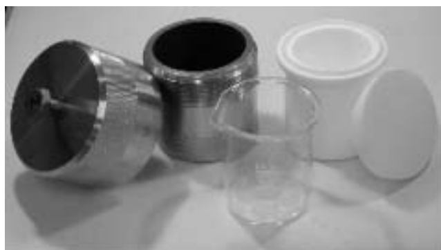
図2 加圧分解容器 The pressurize-decomposition vessel
