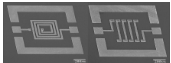
図3 作製したインダクタのSEM写真 (左) スパイラルインダクタ, (右) ソレノイドインダクタ SEM photograph of a fabricated inductor (Left) spiral inductor, (Right) solenoid inductor
