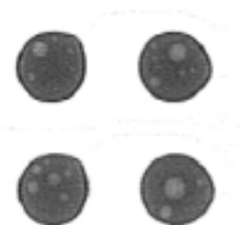
図4 ランド電極上に形成したバンプのX線観察 X-ray image of printed solder bump on Cu electrode
