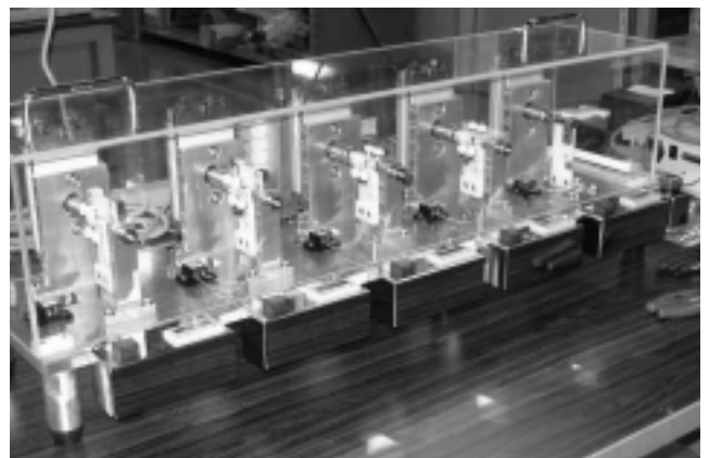
図8 屈曲試験装置 Bending test machine
