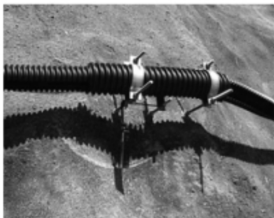
図5 光ファイバセンサ斜面設置状況 Setting situation for optical fiber sensors
