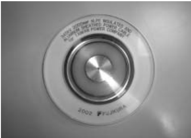
図1 345kV 2,000mm 2 CVケーブル 345kV 2,000mm 2 XLPE cable
