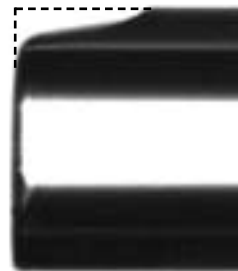
図11 ファイバ端面の欠け(チップ) Chip of fiber end
