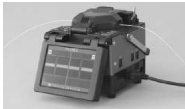
図4 補強スリーブの位置合わせ機能 Centering function of protection sleeve
