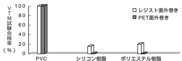
図2 各種樹脂をコーティングした場合の難燃性比較 Flame retardancy of several resins coating film
