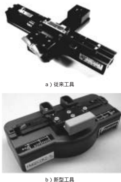
図4 メカニカルスプライス接続工具 Splicing tool for mechanical splice
