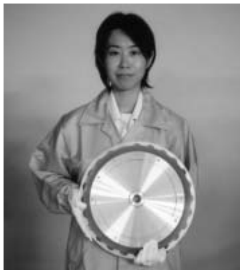
図11 100m級YBCOテープ線材の外観 Photograph of 100m-long YBCO tape
