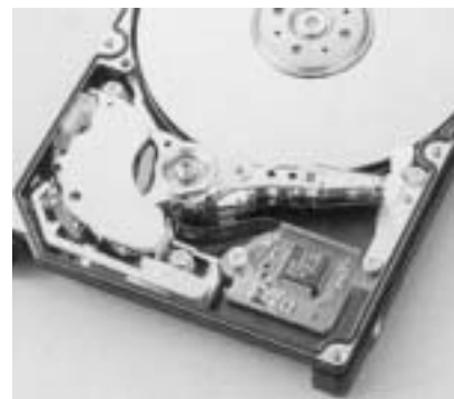
図1 HDDアクチュエータ用FPC Actuator FPC for HDD
