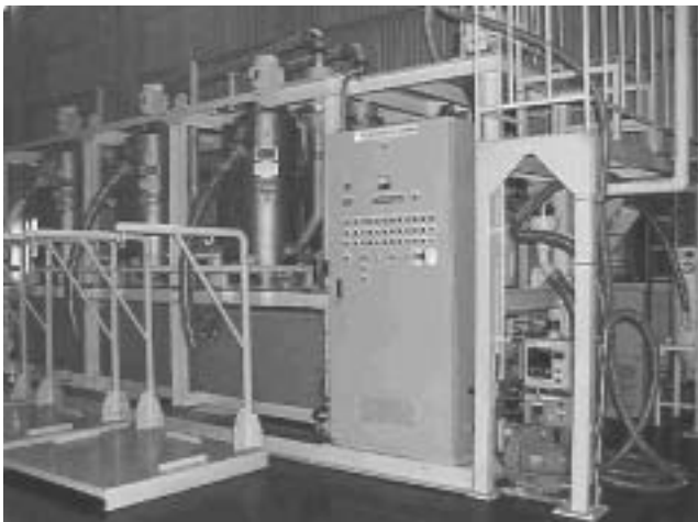
図3 多筒液体サイクロン方式プラスチック分別システム Multistage hydrocyclone plastic sorting system
