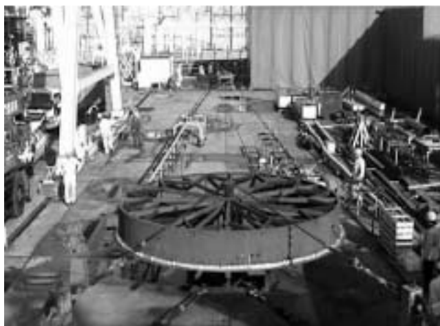
図6 引張り曲げ試験状況 Tensile and bending test
