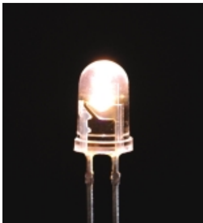
図 8 サイアロン蛍光体を用いた電球色 LED Photograph of SiAlON LED of incandescent lamp color
