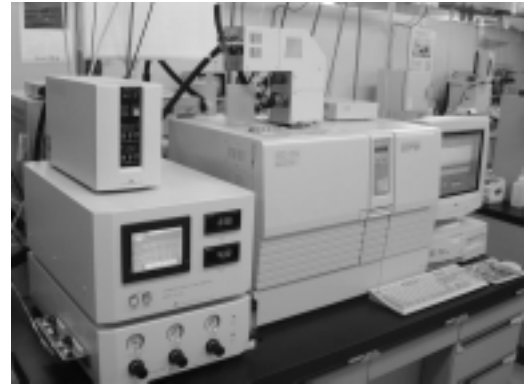
図6 アウトガス測定装置 (GC/MS) Fig. 6. VOC measurement equipment.
