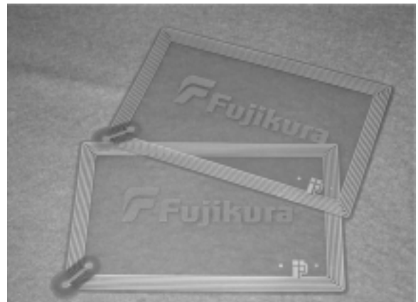
図5 非接触ICカード用アンテナ基板試作品 Fig. 5. Sample of antenna circuit boards for RF-ID tags.
