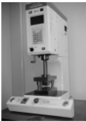
図 6 メタルドーム試作金型の外観 (プレス機組込み) Fig. 6. Appearance of experimental metal die.
