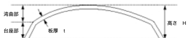
図2 メタルドームの断面形状 Fig. 2. Cross section of metal dome.
