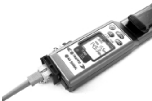
図9 光パワーメータ機能 Fig. 9. Function of optical power meter.
