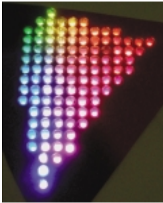
図4 窒化物蛍光体と青色LED素子により試作した様々な色合いのLED
