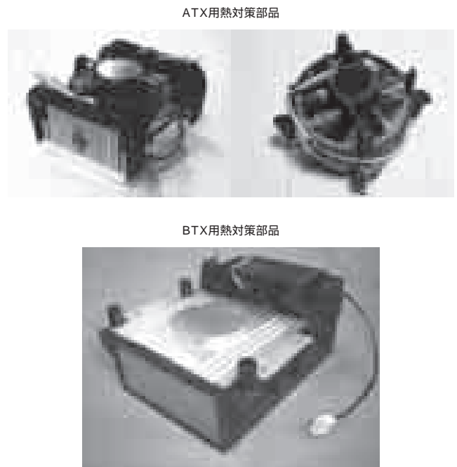
図19 ATX, BTX用の主な熱対策部品 Fig. 19. ATX and BTX typical thermal solution.
