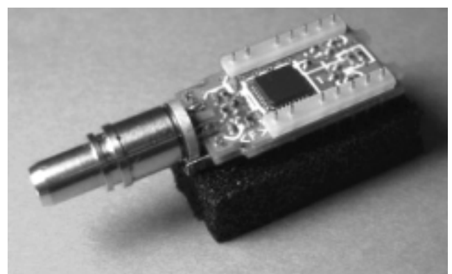
図5 新開発光トランシーバ内部構造 Fig. 5. Internal structure of proposed optical transceiver.
