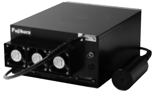
図7 試作ファイバレーザの外観 Fig. 7. Exterior view of developed fiber laser.
