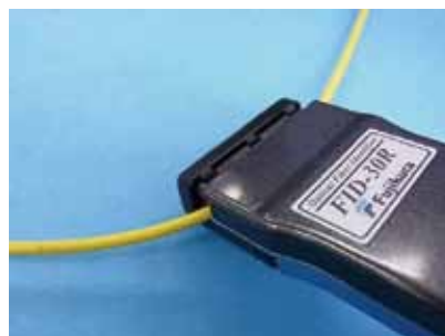
図2 φ 3 mmコードのクランプ Fig. 2. 3 mm coated fiber in clamp.
