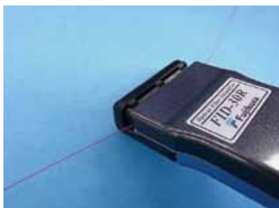
図1 φ 0.25 mm単心線のクランプ Fig. 1. 0.25 mm coated fiber in clamp.
