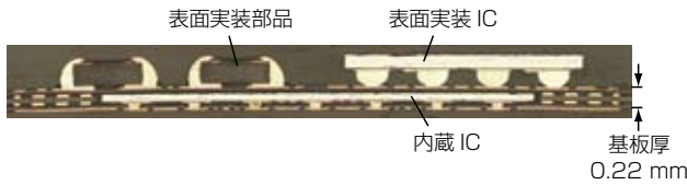
図1 WABE Package ® の断面構造
