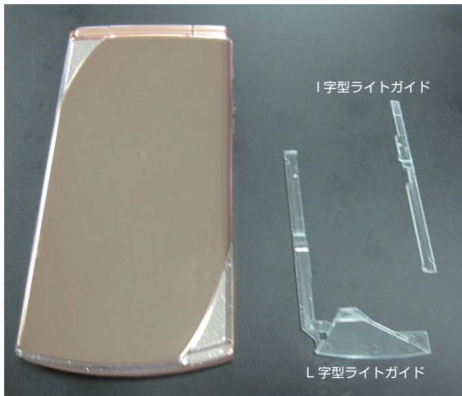
図1 本ライトガイド搭載携帯電話とライトガイド外観
