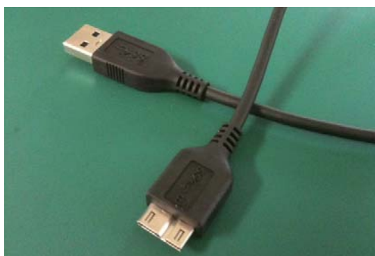
図 3 USB3.0 アセンブリ micro B - standard A
