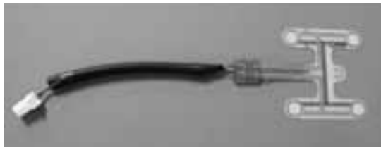
図 1 シートベルトリマイナダー（SBR）用着座センサの外観
