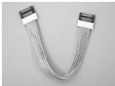
図5 極細同軸加工例2 (FPC接続例)
