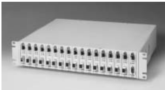
図2 ラックマウントシャーシ （2Uサイズ, 電源2重化対応）
