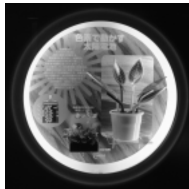
色素で動かす太陽電池 (色素増感太陽電池) (NEDO殿提供)
