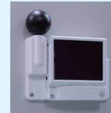
Outer dimensions of indoor sensor node: approx. 149 (W) x 141 (H) x 43 mm (D)
